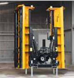
Grâce à sa conception étudiée, le broyeur MU-M/F Vario peut être replié pour un faible encombrement d'entreposage.
