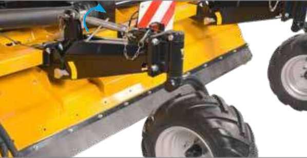
La barre de poussée permet de régler rapidement la hauteur de coupe qui convient.
