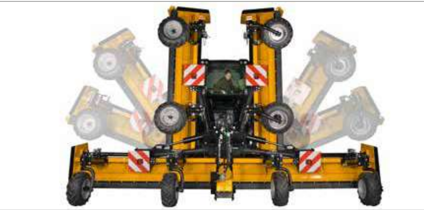
Passage rapide de la position transport à la position de travail. Position de transport dégagée avec une hauteur totale de 3,60 m et une largeur de transport de 2,85 m.
