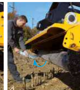
Réglage facile du rouleau d'appui orientable même sans aide supplémentaire.
