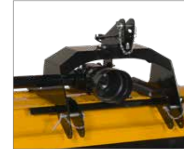
Un support d'attelage trois points spécial Cat. 1 est disponible pour les véhicules porteurs.
