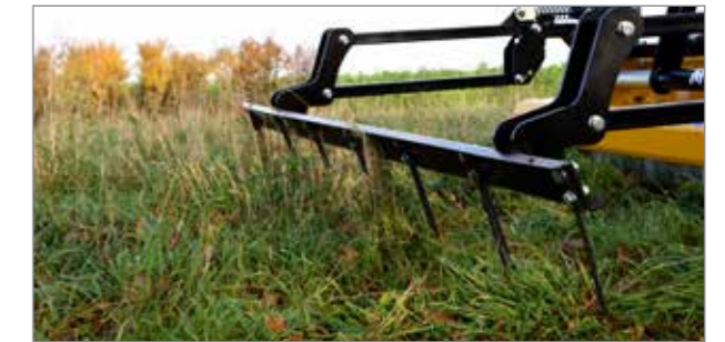
Sauveteur d'insectes : grâce à un étrier spécialement conçu, à repliage hydraulique, à dents coudées intégrées, les insectes et les micro-organismes sont chassés devant le broyeur et poussés à prendre la fuite. (en option pour des largeurs de travail de 1,60 m et 2,20 m)
