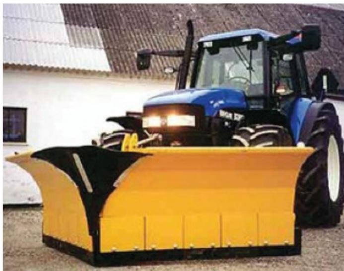
L'étrave SNOWLINE V100 est une lame professionnelle multi-positions robuste de grande dimension qui permet de travailler en diagonale ou en étrave.
