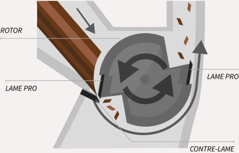
Les broyeurs GTM Professional sont équipés d'un système de broyage par rotor. Il s'agit d'un tambour métallique sur lequel sont montés deux couteaux PRO qui tournent à grande vitesse face à la contre-lame. Grâce à l'effet de traction de ce système et à la force de gravité, les branches sont automatiquement tirées vers l'intérieur et les morceaux de bois sont éjectés avec un haut rendement.
