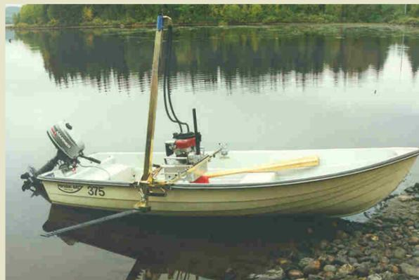
Le Dorocutter Hymo est notre faucardeuse en profondeur. Il travaille latéralement. L'entraînement de la coupe est hydraulique, d'une efficacité optimale. Il est livré avec le groupe de puissance **hyddo 200** et un châssis réglable adaptable à la plupart des petites embarcations. La barre de coupe est protégée par le système de sécurité mécanique à ressorts.
