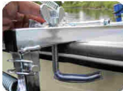
Les châssis des Dorocutters sont télescopiques pour s'adapter à la largeur des différentes embarcations. Des mains de fixation permettent d'ancrer solidement les appareils sur les plats bords.
