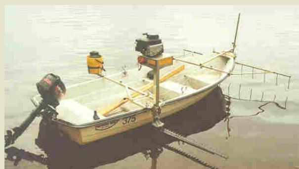
Le Dorocutter Wasse est notre plus petite machine à moteur thermique. Il est adapté aux petites surfaces. Toutes les commandes du moteur et de réglage de profondeur de coupe sont accessibles du poste de pilotage du bateau. Son poids réduit rend la maintenance aisée. Il est équipé de la protection mécanique de la coupe. Le râteau est adaptable en option.
